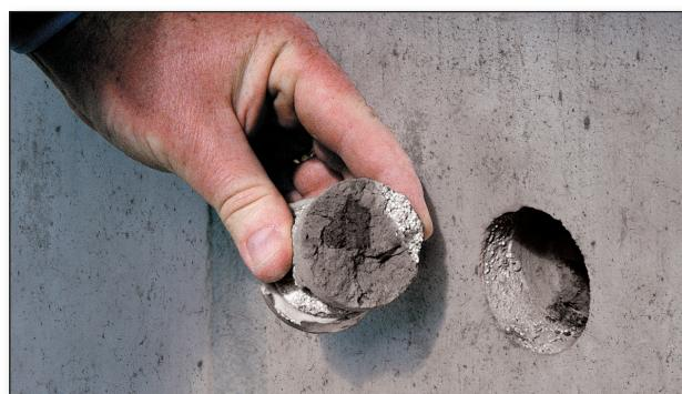
Aussagekräftige Untersuchungsergebnisse setzen eine sachgerechte und zielgerichtete Probenentnahme voraus. Untersuchungsziel und -methode geben Menge und Art der Proben vor. Dabei muss die Anzahl der Proben die verschiedenen Schadensformen, Baustoffe und Bauteile berücksichtigen.
